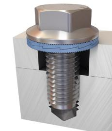
Za pritrjevanje v podolgovate luknje ali pri mehkih površinah materialov, uporabljamo priročnični vijak/matico v kombinaciji z NORD-LOCK "sp" (povečani zunanj premer) podložko.
