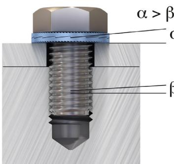
Ko pritrdimo vijak oz. matico se rebrasta površina varovalne podložke NORD-LOCK vtisne v površine vijaka in podlage. S tem so premiki možni samo med naklonskimi površinami. Vsaka rotacija vijaka/matrice v smeri odvita je blokirana zaradi povečanja natezne sile.
