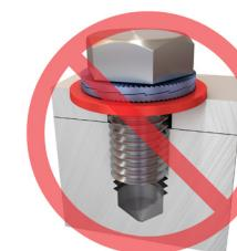
NORD-LOCK podložke se ne sme uporabljati na dodatnih podložkah, ki niso fiksirane.
