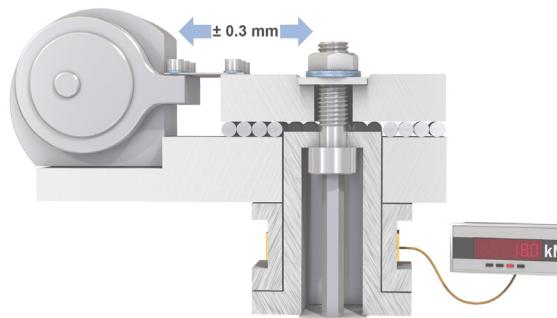
Junker vibracijski test po standardu DIN 65151 je odlična metoda za preizkušanje in primerjavo varnosti vijačnih zvez. Pri tem testu je vijačna zveza izpostavljena prečnim premikom, medtem ko se natezna napetost nenehno meri z merilno celico.
