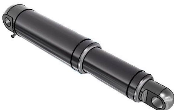
Slika 8: Primer 3D modela električnega aktuatorja CON50 (premer 50mm)
